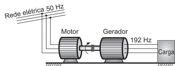
Um gerador síncrono de oito pólos é acionado por um motor de indução de dois pólos, conforme ilustrado na figura acima. O gerador alimenta uma carga que está isolada da rede elétrica, cuja frequência é de 50 Hz. Observou-se que a frequência da tensão gerada pelo gerador síncrono é igual a 192 Hz. Com base nas informações dadas, qual é o valor percentual do escorregamento do motor de indução?
