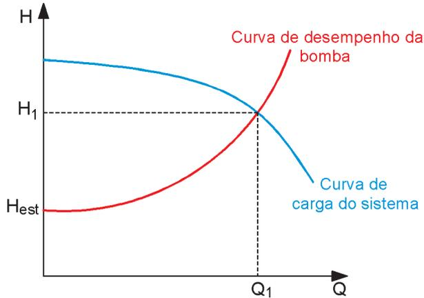
Considere um sistema de bombeamento de fluidos utilizando uma bomba centrífuga acionada por um motor elétrico. A curva de desempenho da bomba é um dado fornecido pelo fabricante, que relaciona a vazão do fluido bombeado (Q) com a pressão (H) fornecida pela bomba ao fluido, para uma dada velocidade de rotação da bomba (N).
