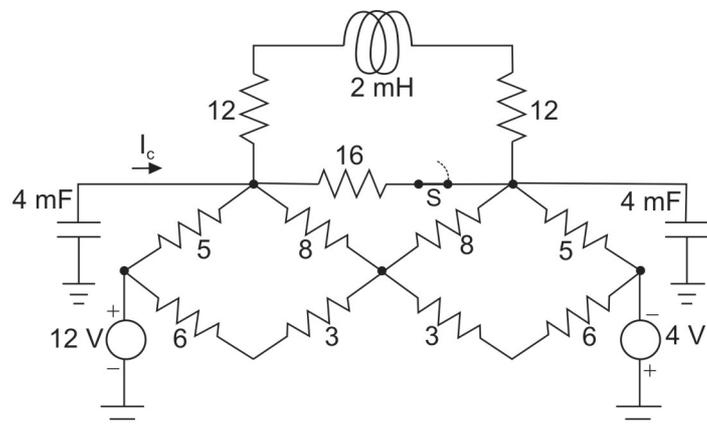
A figura acima apresenta um circuito contendo algumas simetrias, alimentado por duas fontes de tensão contínua. Os valores das resistências estão em ohms. Considere que o circuito esteja funcionando em regime permanente, com a chave S fechada.
