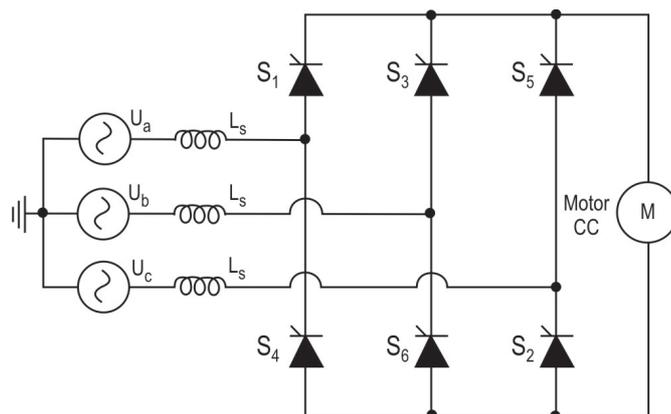
Um motor de corrente contínua série é acionado por um conversor trifásico a tiristores, conforme mostrado na figura acima.
