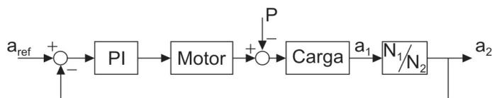
No diagrama, PI é um controlador proporcional integral,  $N_1/N_2$  é a relação entre engrenagens,  $a_1$  é a posição angular antes do acoplamento,  $a_2$  é a posição depois do acoplamento, e  $a_{ref}$  é a referência de posição.
