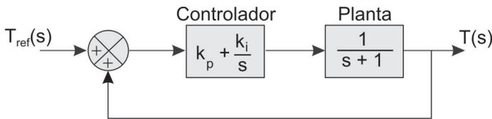
Nesse diagrama,  $T_{ref}(s)$  corresponde à referência de temperatura e  $T(s)$ , à temperatura da planta (forno elétrico). Nessa situação, considere as afirmações a seguir.
